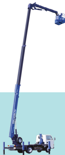
高所作業車（スカイボーイ）
